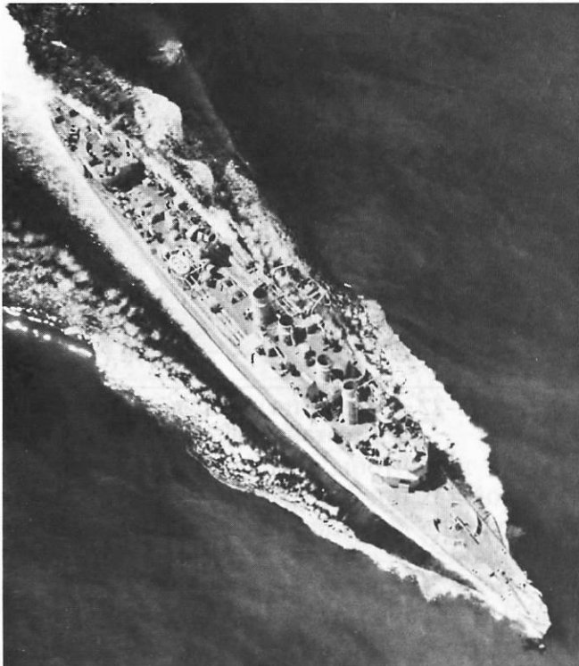
Обычный корабль на полном ходу должен раздвинуть своим носом массу воды, которая вытесняется на поверхность в виде волн. На это тратится очень много энергии
