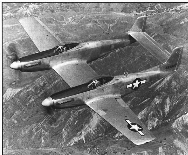
Два фюзеляжа "Мустанга" и новое крыло – вот и новый "Твин Мустанг"
