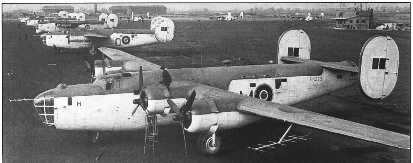
"Либерейторы" противолодочной эскадрильи Берегового командования Великобритании, оборудованные поисковыми локаторами
